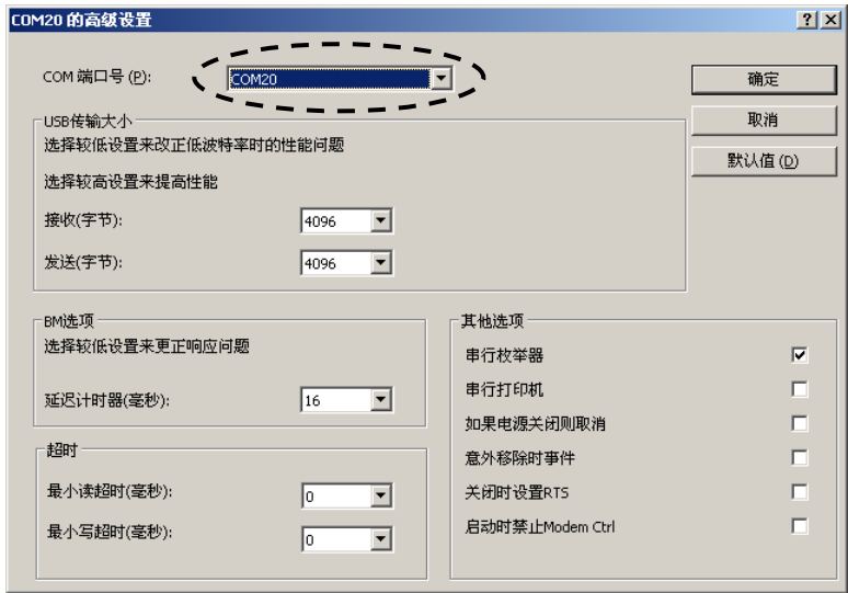
图 3-29 修改 RS-232C/USB 转换器的端口号
