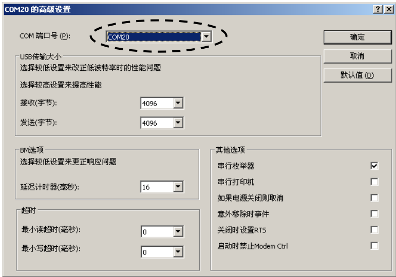
图 3-28 修改 RS-232C/USB 转换器的端口号
