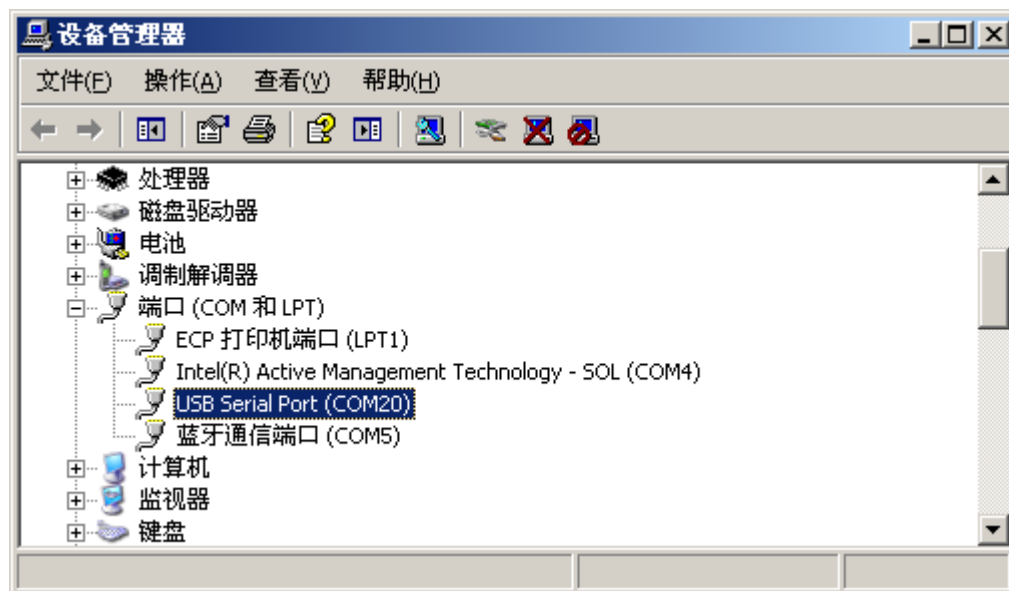
图 3-26 设备管理器中的 RS-232C/USB 转换器设备
