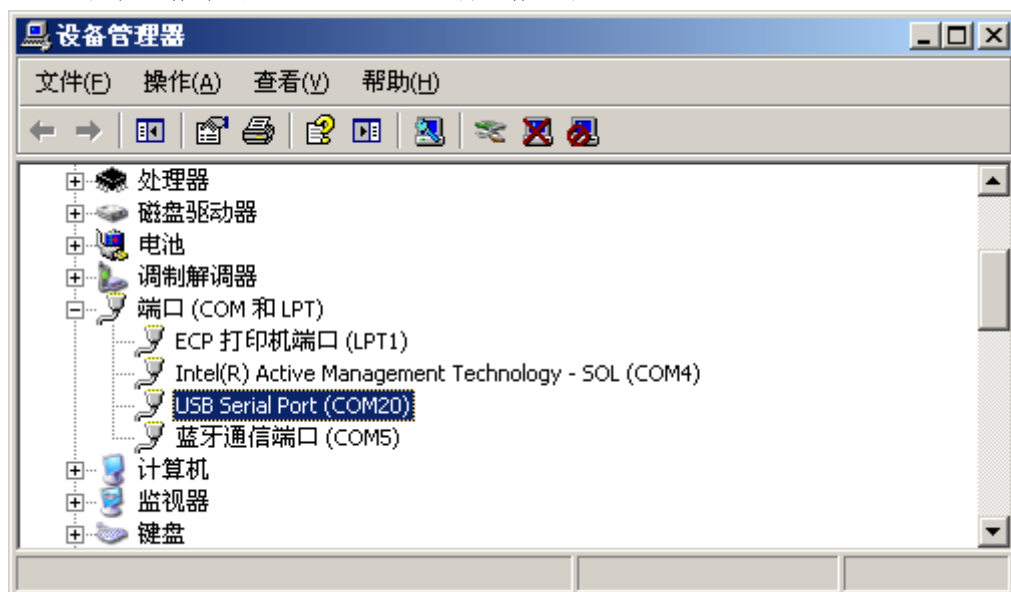
图 3-27 设备管理器中的 RS-232C/USB 转换器设备
