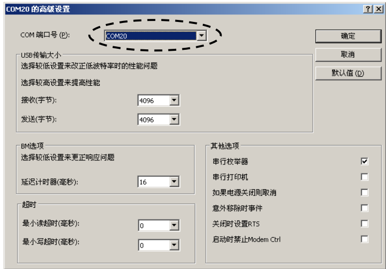
图 3-29 修改 RS-232C/USB 转换器的端口号
