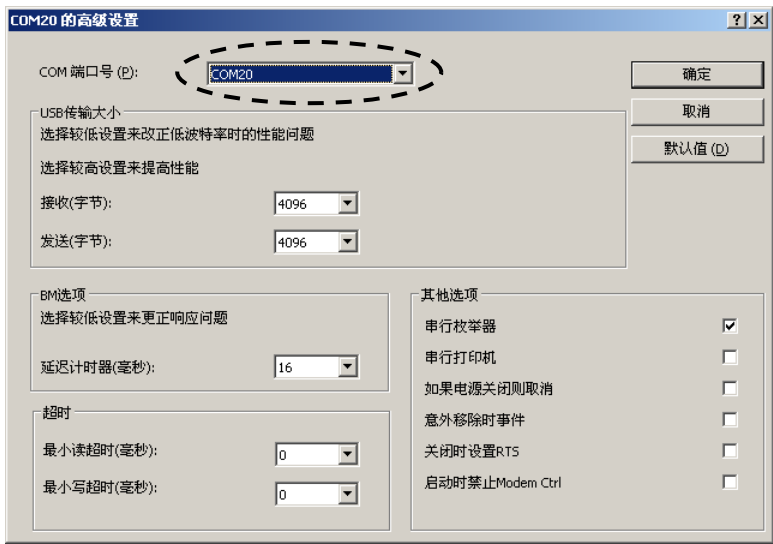
图 3-27 修改 RS-232C/USB 转换器的端口号
